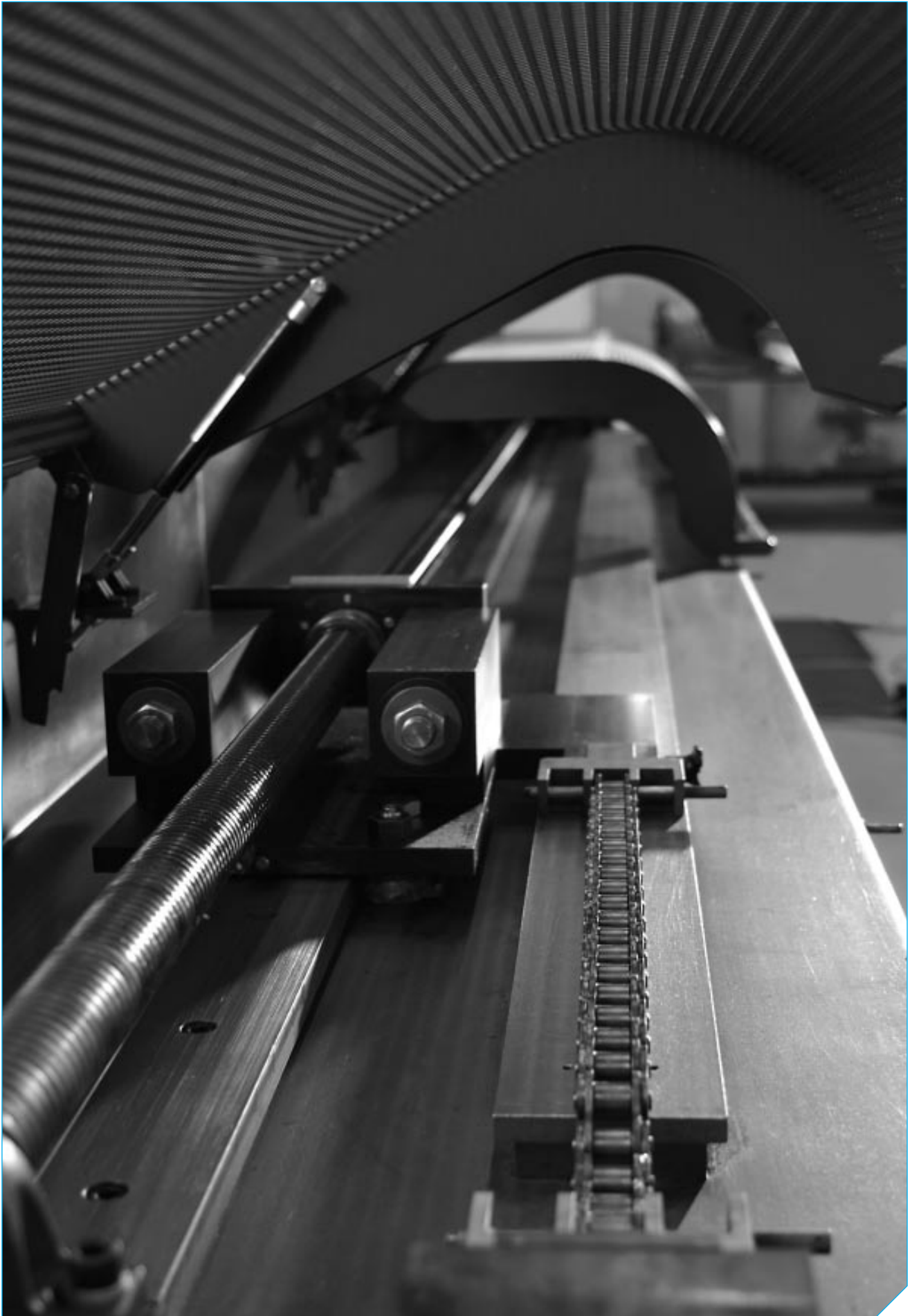
Matchy – Vorrichtung zum paarweisen Vorrecken für Parallellauf
