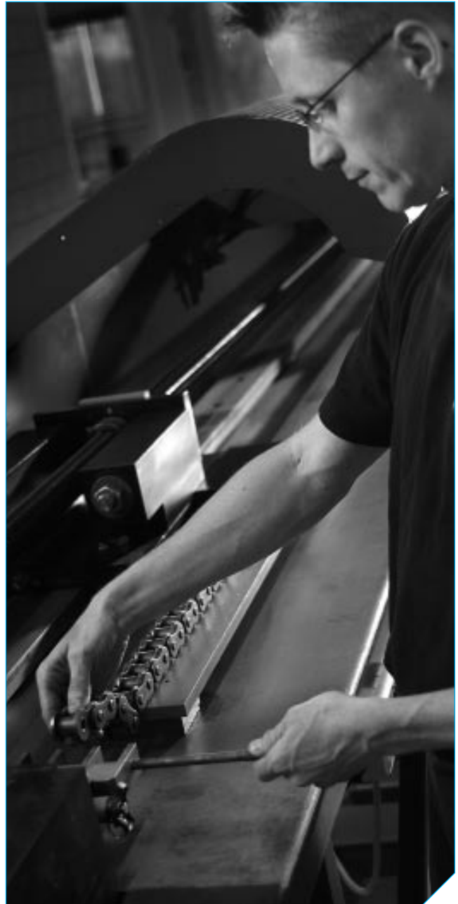
Abb. 20 Paarweises vorrecken für Parallellauf
