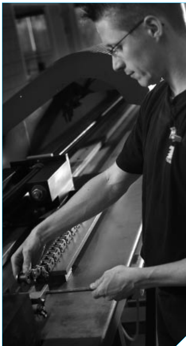
Fig. 20 : Appairer des morceaux de chaîne
