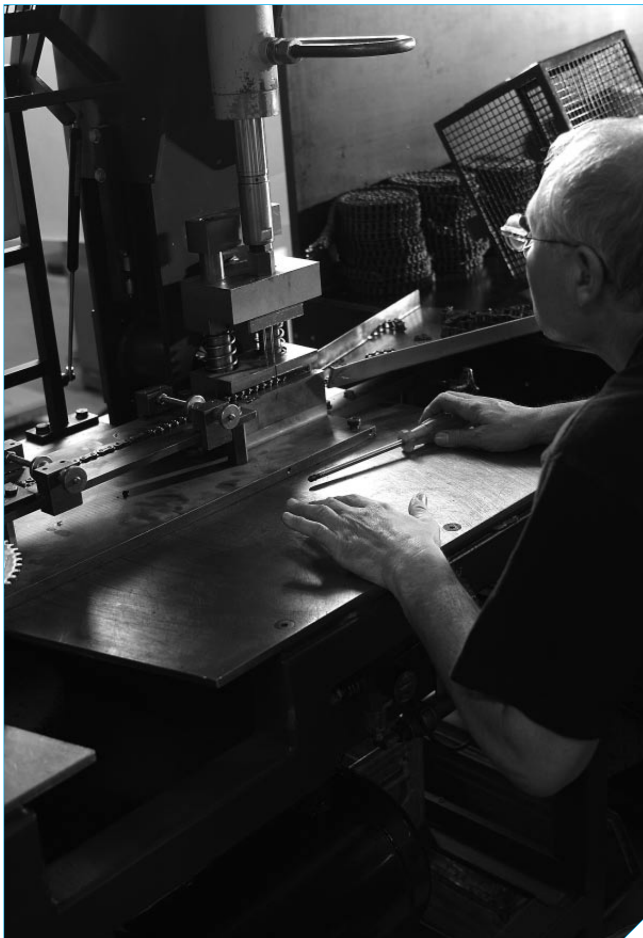
Couper une chaîne en petits morceaux afin de pouvoir monter des attaches (à Dordrecht)
