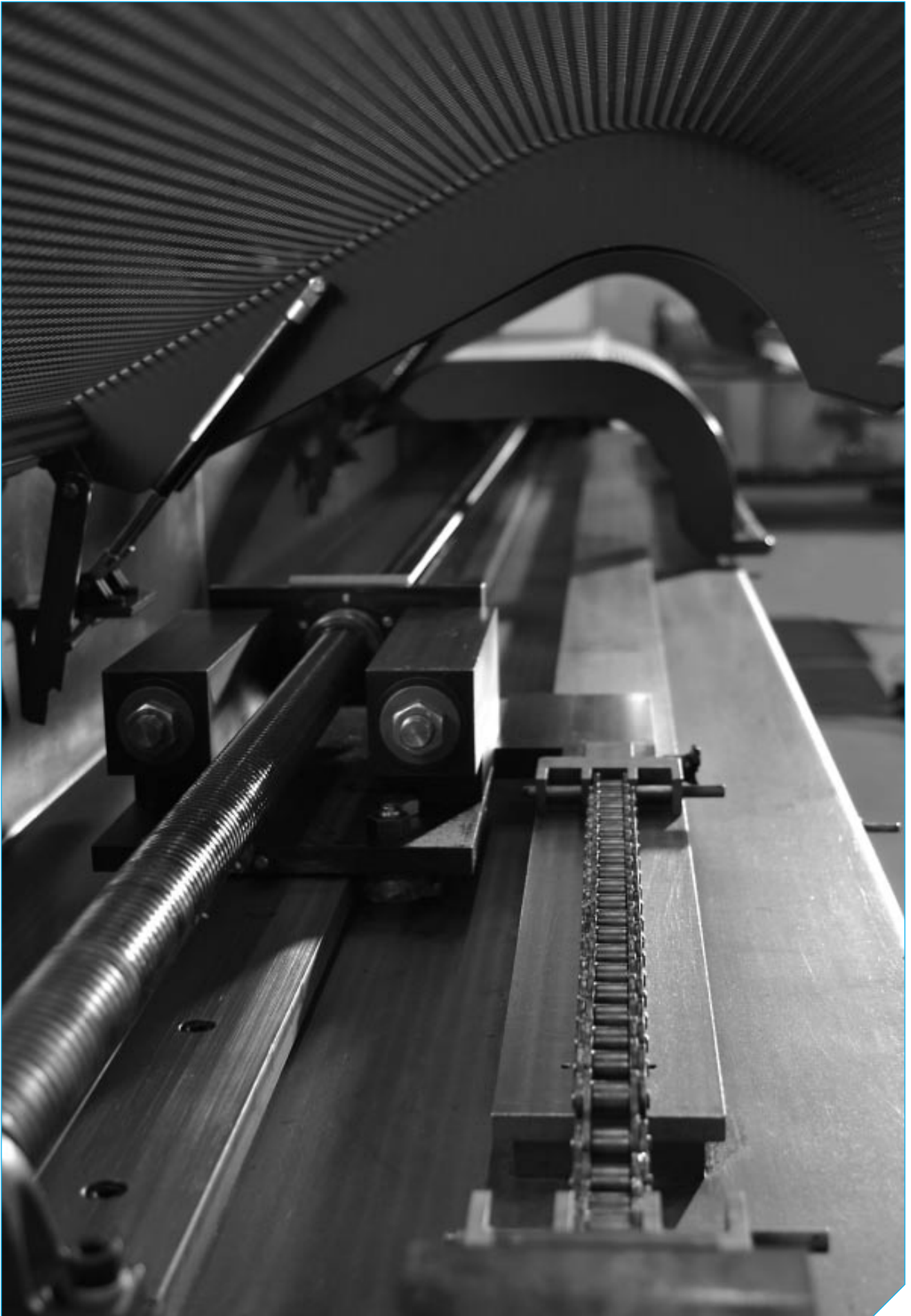
Kettinglengte meetapparatuur (de "Matchy")
