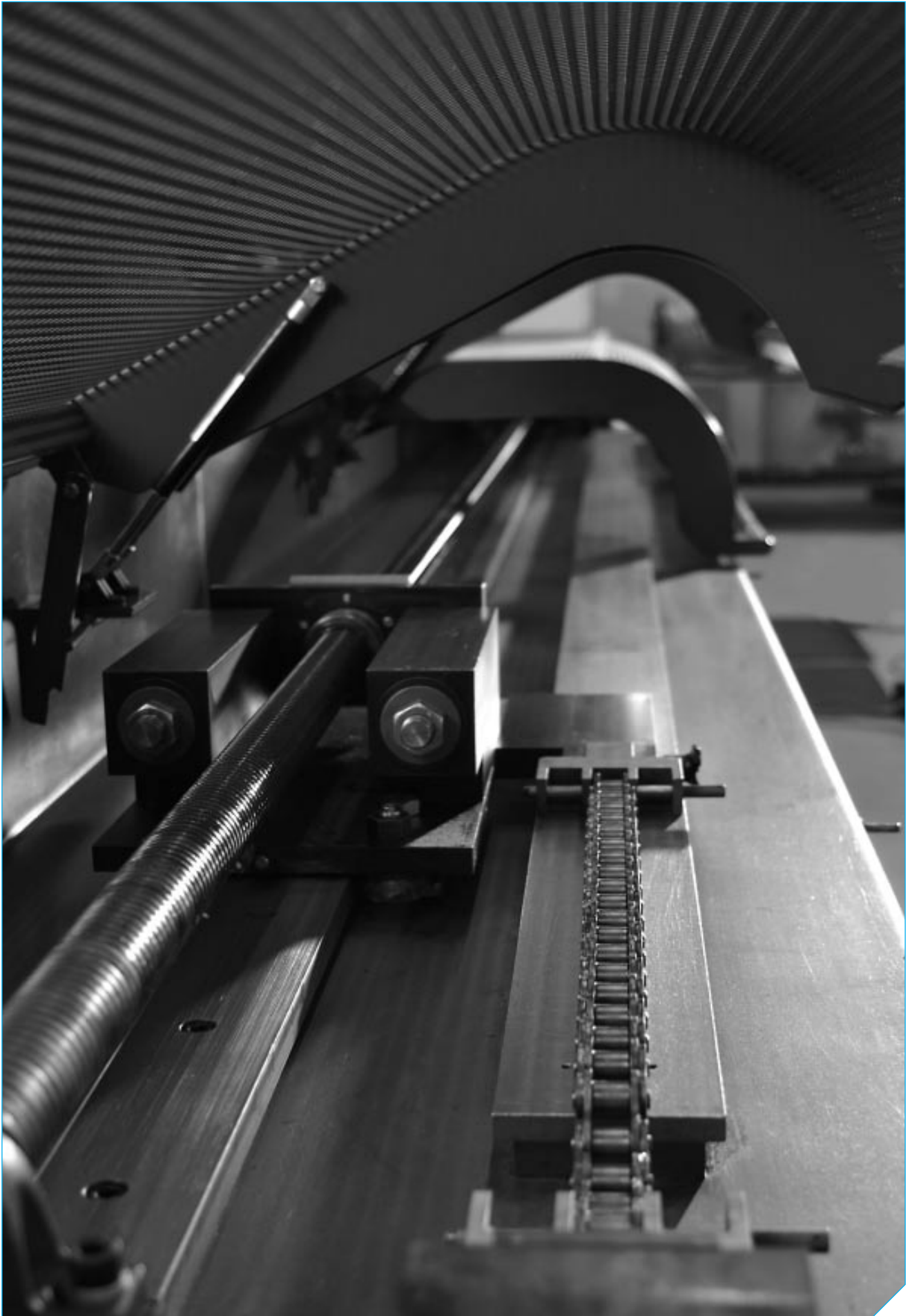
Kettinglengte meetapparatuur (de "Matchy")
