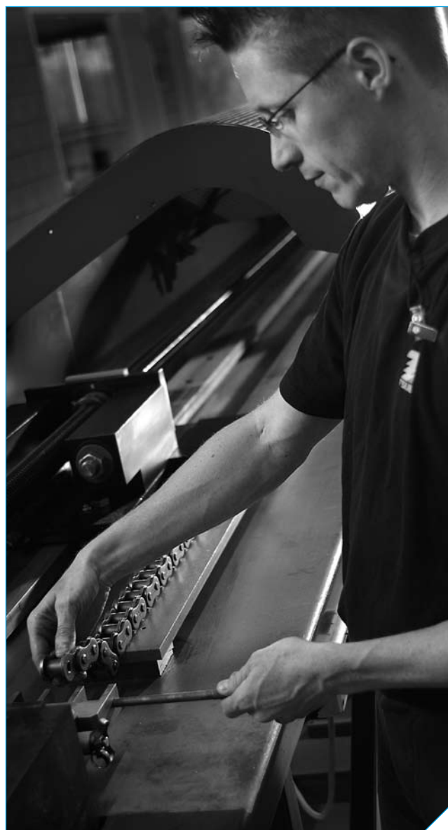
Fig. 29 Appairer des morceaux de chaîne
