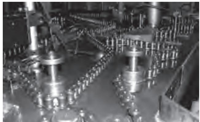
Nach dem ersten Betrieb neigt die Rollenkettenkette dazu, sich etwas zu längen (ca. 0,05%). Diese Anfangslängung verursacht einen übermäßigen Durchhang, der entsprechend nachgestellt werden muss. Verwenden Sie bitte einen Kettenspanner, falls das System für ein solches Werkzeug ausgelegt ist. Falls ein Kettenspanner jedoch nicht geeignet ist, lässt sich der Durchhang durch Bewegen der Wellen einstellen. Die Kette wird nun ordnungsgemäß verwendet; die Längung nimmt daher beträchtlich ab.
