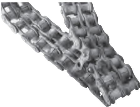
Korrosion einer Rollenkette aus Edelstahl
