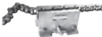
Einsetzen der Kette in einen Kettenspannstock
