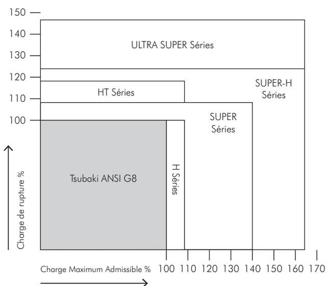
Fig. 16 : Comparaison de la charge de rupture / à la Charge Maximum Admissible
