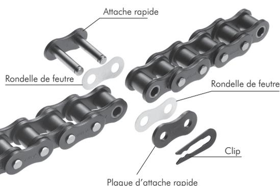
Fig. 12 Raccordement d'une chaîne X-LAMBDA BS
